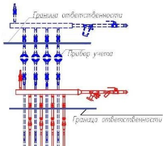
Границей ответственности по отоплению между Управляющей организацией и Заказчиком является точка первого резьбового соединения на распределительном коллекторе подающего и обратного трубопровода в распределительном этажном шкафу.
