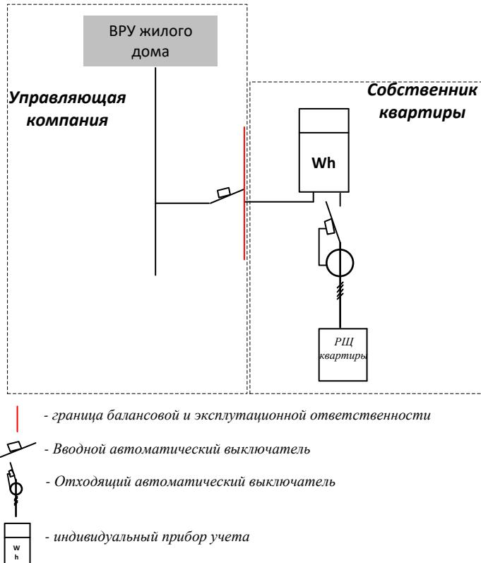
Граница балансовой и эксплуатационной ответственности проходит по выходным клеммам входного автоматического выключателя в сторону квартиры.
